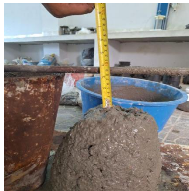
Gambar 4.3 pengujian Slump Test
