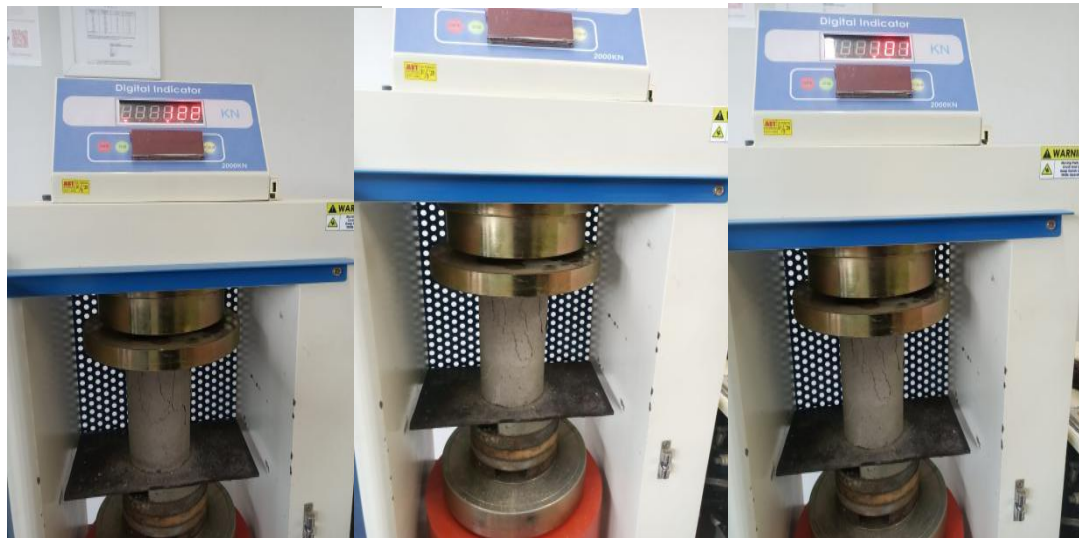
Gambar 4.8 Pengujian Kuat Tekan beton
